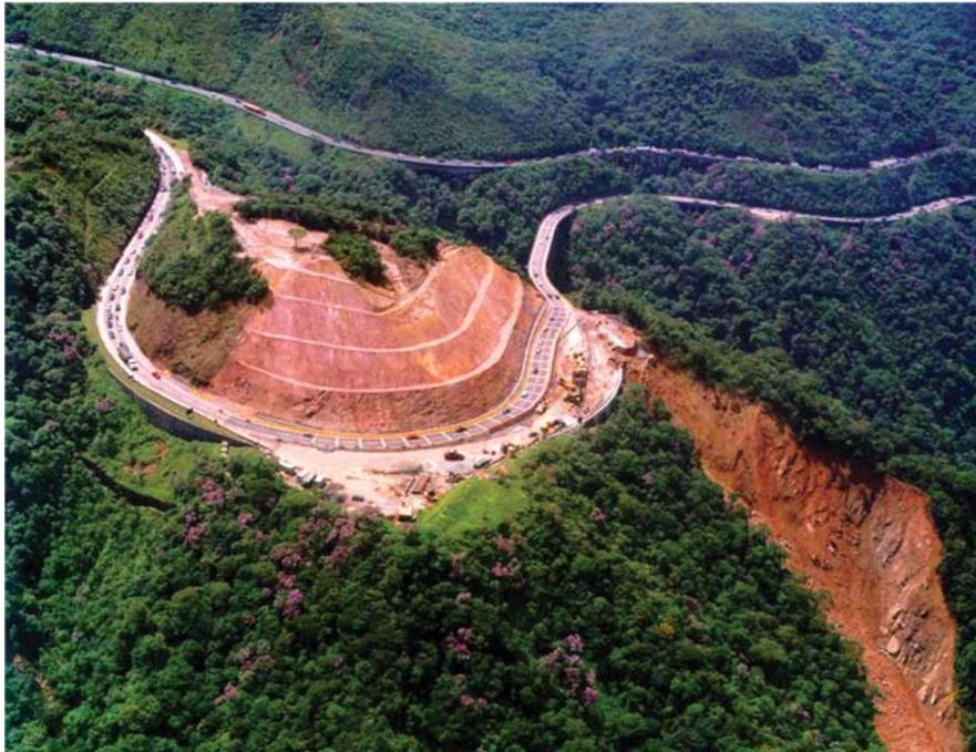
**Foto 1:** Avaliação de estabilização definitiva e do dano ambiental no escorregamento de 500.000 m<sup>3</sup> de solo e rocha, ocorrido no km 42 da Rodovia Anchieta.
